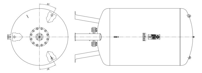
ergänzen mit Ms-Kappe+Dichtung Anziehdrehmoment 15Nm+10Nm ø1200 DN65/PN16 DN250/PN16 Ø1070 ±20 \_ 85 (288) 460±5 2500±20 Membranbruchmelder nur auf Kundenwunschl Ansonsten Verschlußstepfen Ms R½ mit Innensechskant eingeklebt (Loctite) und mit Siegellack gesichert.
